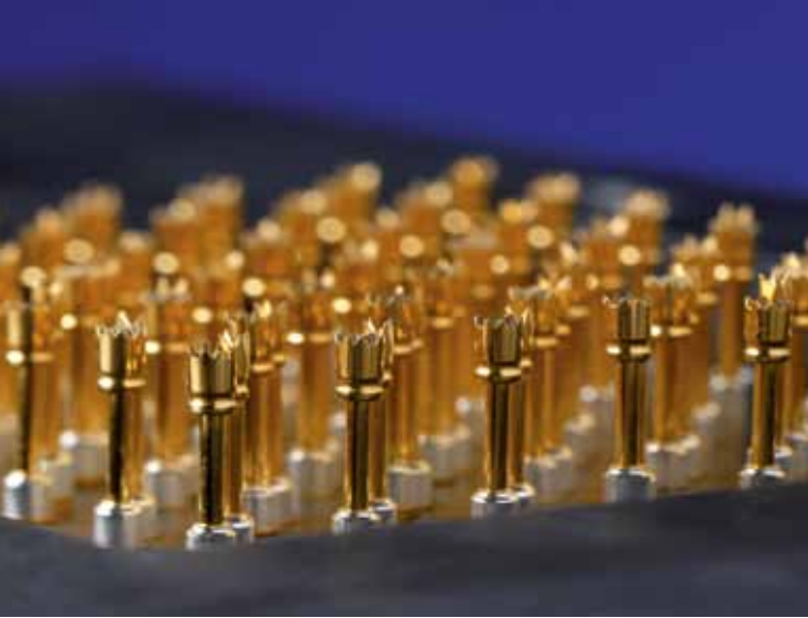
Federkontaktstifte zur Stromableitung an einer segmentierten Brennstoffzelle. Bild: Fraunhofer ISE
